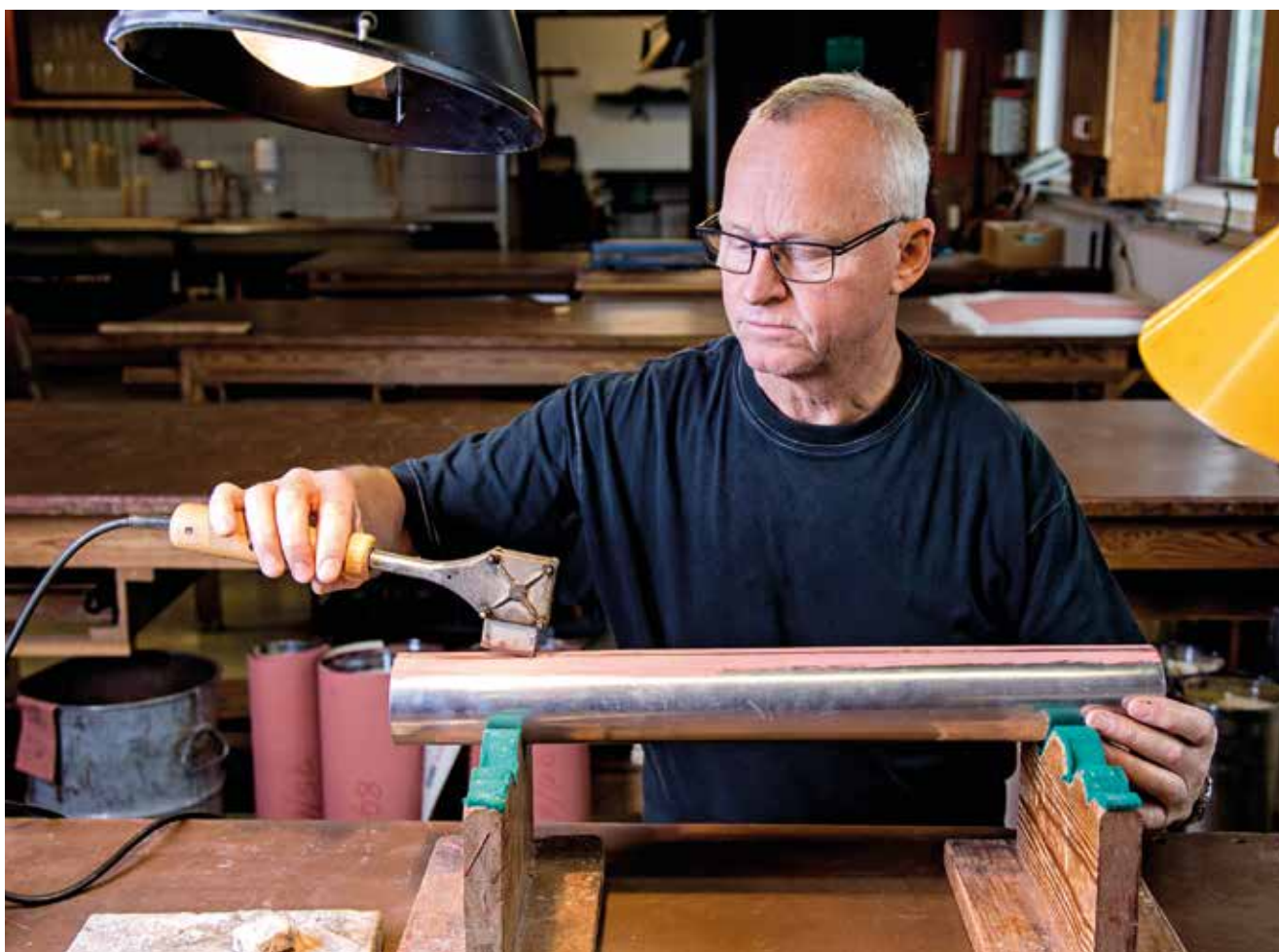
Bende Schmidt smelter, smeder og finjusterer de lange tynde metalrør, der står forrest i orglet. Det gør han som orgelbygger hos Bruno Christensen i Tinglev. Det tager fem orgelbyggere 10 måneder at bygge ét orgel.
